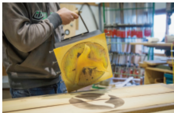
Nach dem Pressen werden die Skis entlang der Kanten ausgeschnitten. Schwab presst immer paarweise – das Muster des Holzes findet sich gespiegelt auf beiden Skis. Bilder: Carole Lauener
