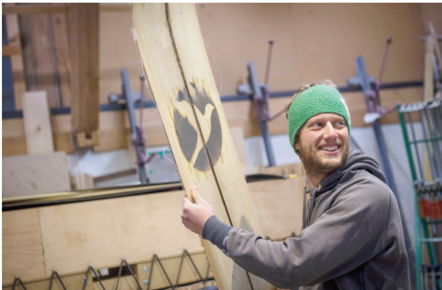
Nach dem Pressen werden die Skis entlang der Kanten ausgeschnitten. Schwab presst immer paarweise – das Muster des Holzes findet sich gespiegelt auf beiden Skis. Bilder: Carole Lauener
