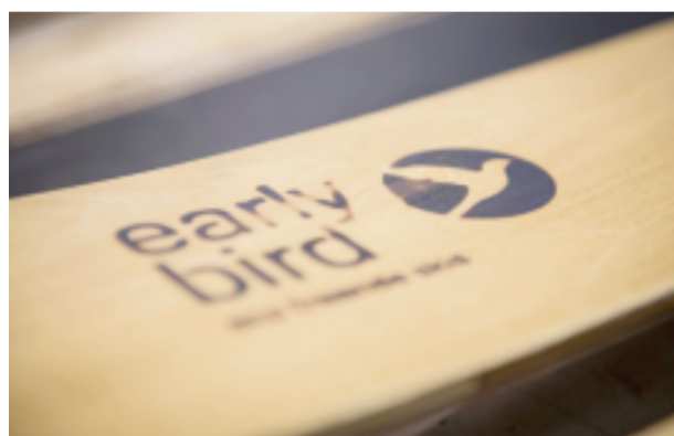
Das Logo, ein flatternder Vogel, wird eingebraunt, nicht lackiert. Earlybird-Skis entstehen zu einem guten Teil in Handarbeit, die Presse ist selbstgebaut.
